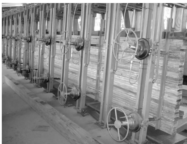
Figura 04 – Prensagem das vigas MLC.
