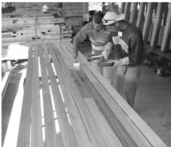
Figura 03 – Aplicação do adesivo.
