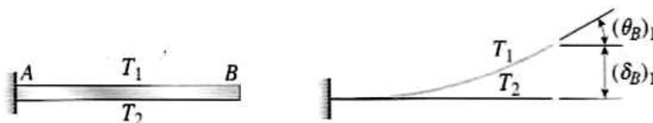
Figura 2 – Viga engastada sob ação de variação não-uniforme de temperatura
