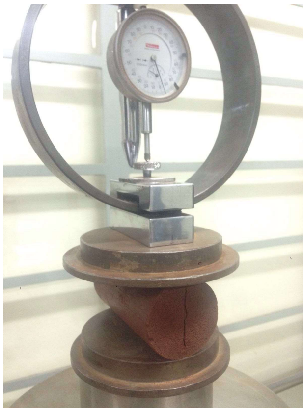
Figura 6 – Plano de ruptura do corpo de prova na compressão simples
