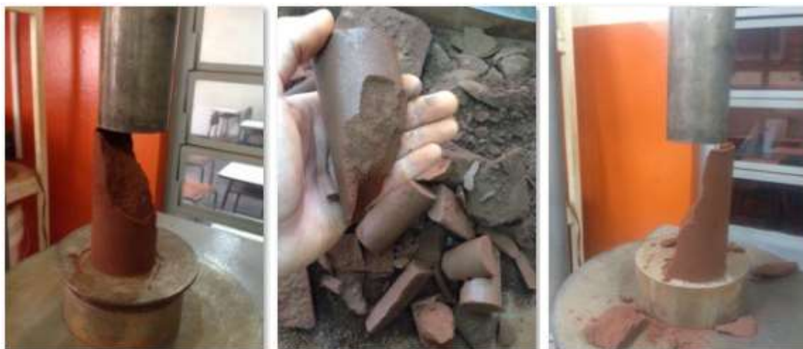
Figura 5 – Plano de ruptura do corpo de prova na compressão simples
