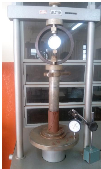
Figura 8 – Prensa utilizada para rompimento.
