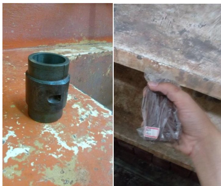
Figura 5a – Cilindro metálico para moldagem dos CPS; Figura 5b- Corpo de prova ensacado.
