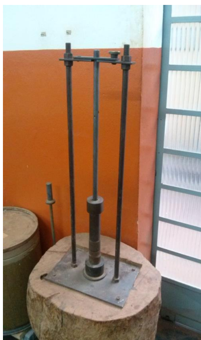
Figura 7 – Equipamento utilizado para moldagem dos CPs.
