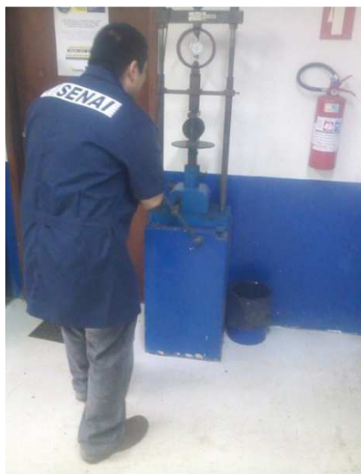
Figura 7 – Corpo de prova submetido ao ensaio de RTCD
