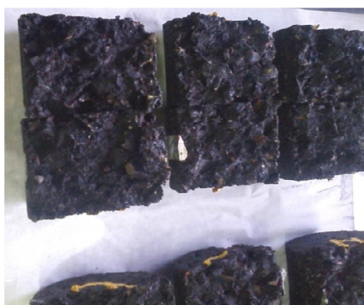
Figura 11 – Corpo de prova com CAP-BMP rompido após ensaio D.U.I.
