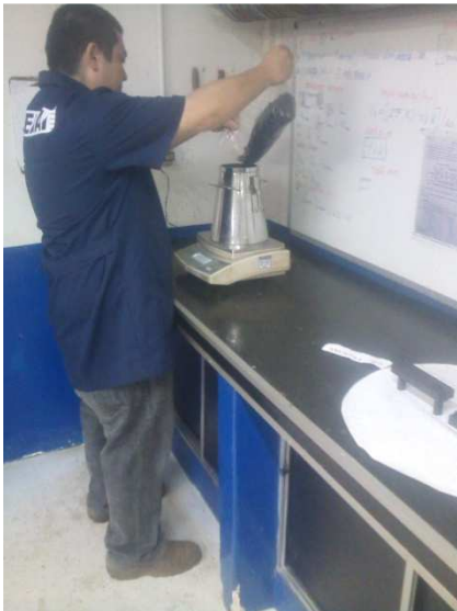
Figura 5 – Pesagem da amostra RICE TEST. Fonte: Os Autores (2016)
