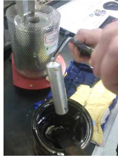
Figura 4 – Descarte da amostra após o ensaio de viscosidade cinemática Brookfield Fonte: Os Autores (2016)
