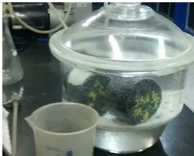
Figura 8 – Ar sendo retirado dos corpos de prova
