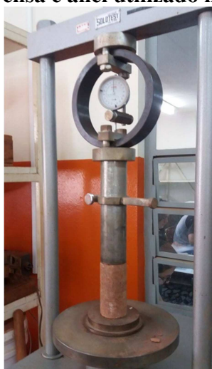
Figura 2 – Prensa e anel utilizado no ensaio RCS
