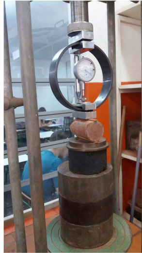
Figura 3 – Prensa e anel utilizado no ensaio RTCD
