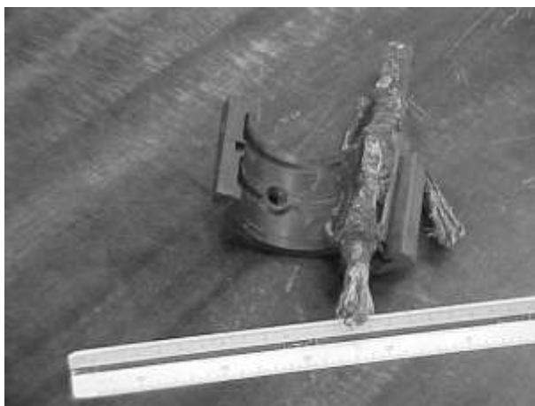
Figura 1 – Interferência de raiz de espécime arbóreo no colar de tomada
